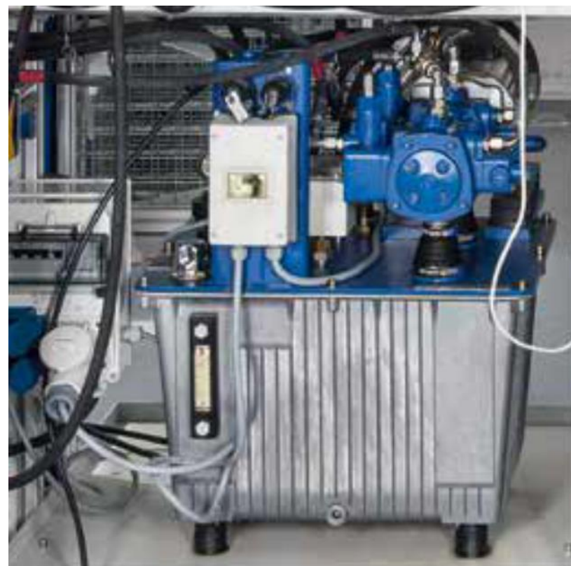
Fig. 6. Modulul hidraulic de generare și distribuție al unui stand pentru testarea cilindrilor hidraulici
