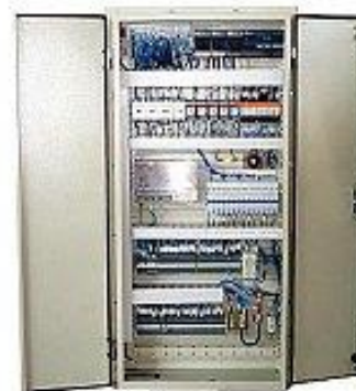
Fig. 8. Modulul electric general al unui stand pentru testarea cilindrilor hidraulici
