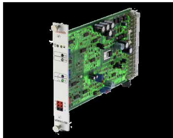
Fig. 9. Modulul electric și electronic de comandă al unui stand pentru testarea cilindrilor hidraulici
