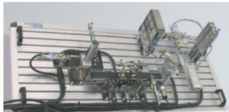
Fig. 3. Modulul mecanic de forță al unui stand pentru testarea cilindrilor hidraulici
