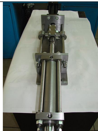
Dispozitiv pentru probarea etansărilor pistoanelor cilindrilor hidraulici
