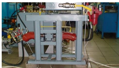
Stand transmisii hidraulice pentru turbine eoliene
