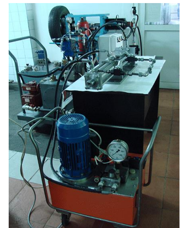
Stand pentru probarea etansărilor pistoanelor cilindrilor hidraulici
