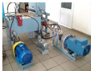
Stand transmisii hidraulice pentru turbine eoliene
